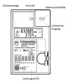
Um Ihre persönlichen Daten vor dem Zugriff Unbefugter zu schützen, ist der EDL21-Zähler im Auslieferungszustand durch eine vierstellige persönliche Identifikationsnummer (PIN) gesichert. Die Informationen zum aktuellen Verbrauch, die in der zweiten Displayzeile angezeigt werden, sind somit zunächst ausgeblendet.
